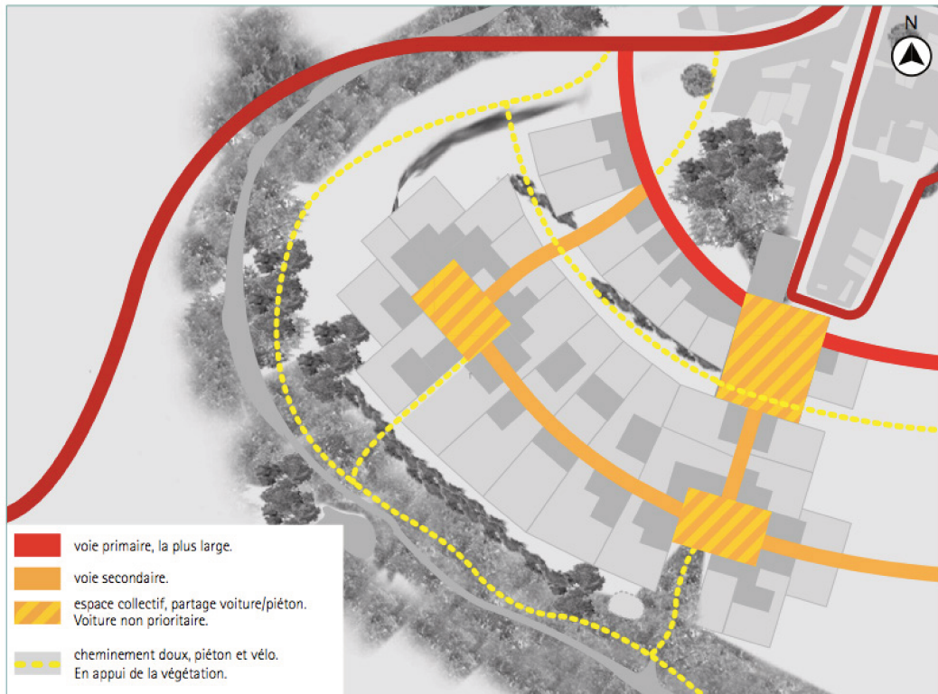
Figure 16. Connexion au réseau existant, hiérarchisation de la trame viaire et prise en compte des mobilités piétonnes : construire la « ville passante » (CAUE de Vendée, 2009, p.51)
