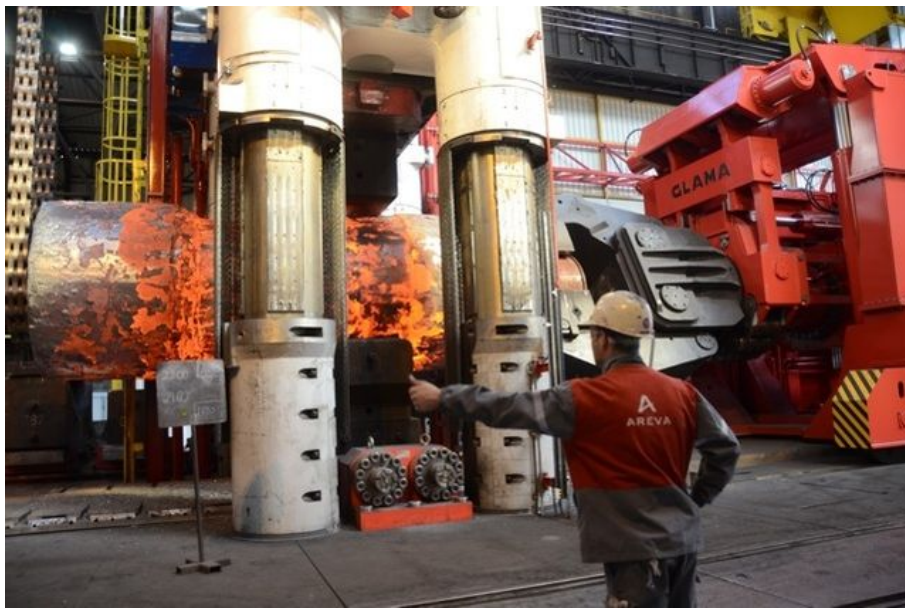
Figure 1.2 – Lingot en cours de forgeage.
