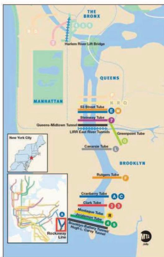
**Figure 80 : Les tunnels et ponts abîmés pendant Sandy autour de Manhattan. Le fond de carte montre les infrastructures intactes. [MTA, 2012]**
