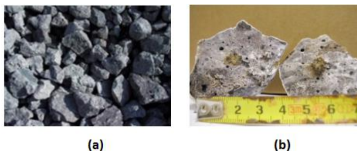
Figure 2.3 : Laitiers d'aciérie de conversion avec vue globale (a) et vue détaillée montrant les nodules de chaux (points noirs) dans un grain (b) (d'après CTPL, 2004).
