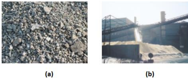
Figure 2.2 : Laitiers de haut-fourneau cristallisé (a) et vitrifié (b) (d'après CTPL, 2004).
