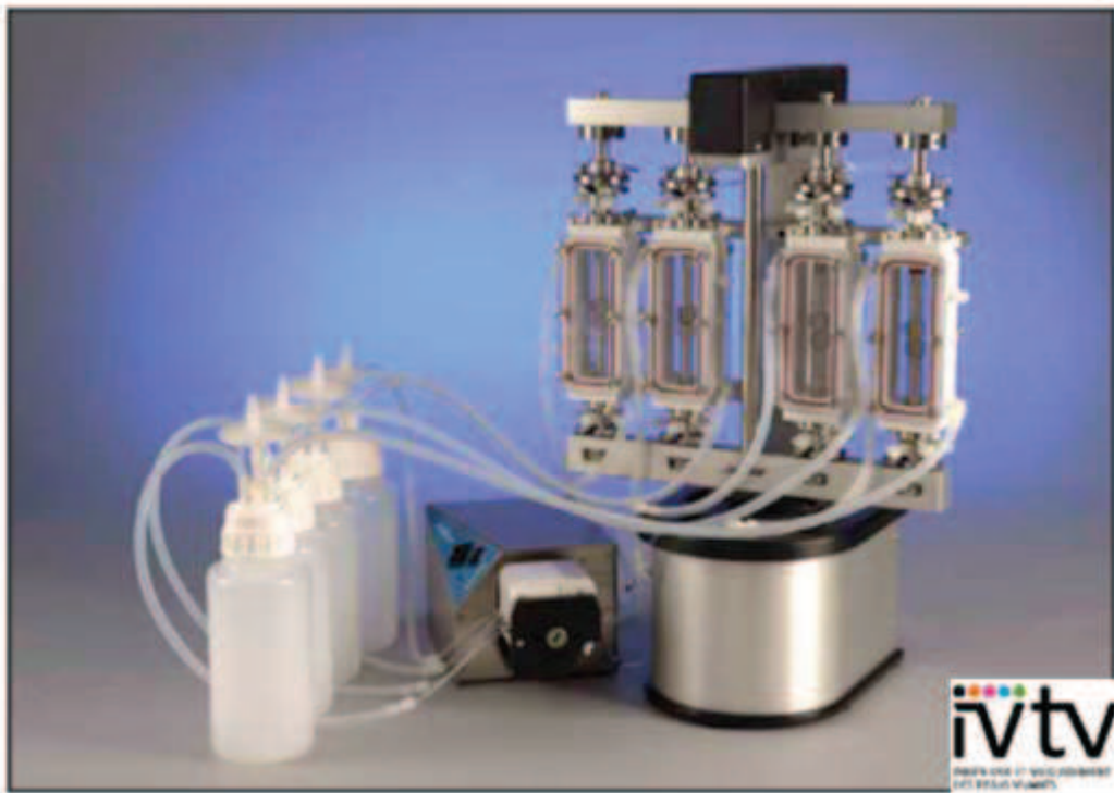
Figure IV-8. Bioréacteur de perfusion Bose ElectroForce 5270 BioDynamic mis à disposition par la plateforme ivtv.
