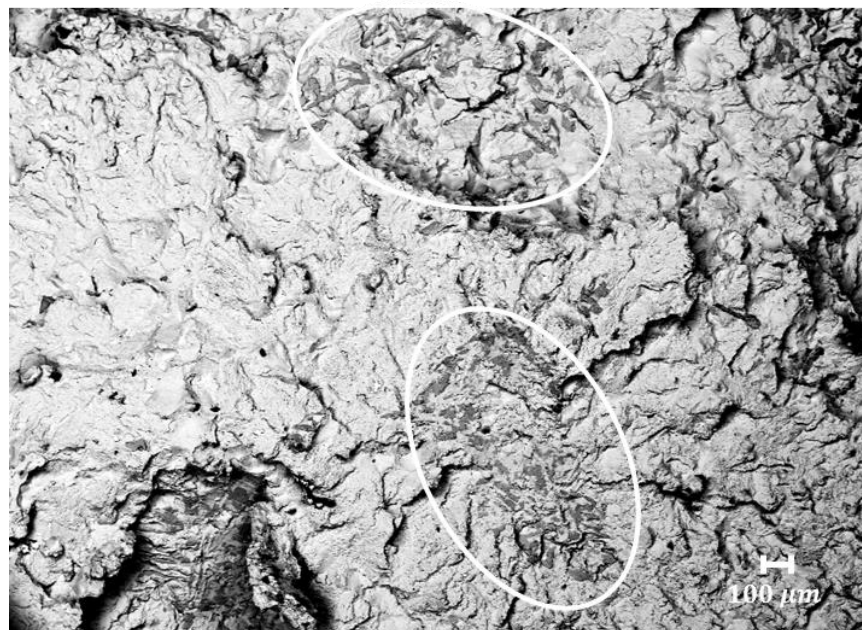
Figure 51 - Faciès de rupture de la DDH ouverte ; amas de MnS secondaires au voisinage de l'amorce principale
