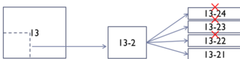
Figure 33 - Partition en tranches d'un échantillon contenant une DDH détectée par contrôle US.
