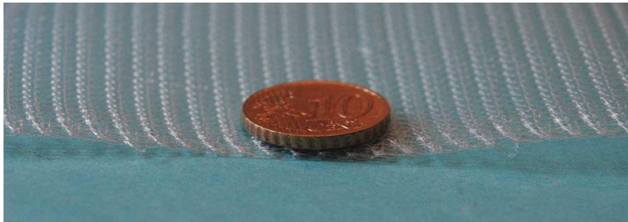
Figure 3.1: Photographie des drainants utilisés en infusion.
