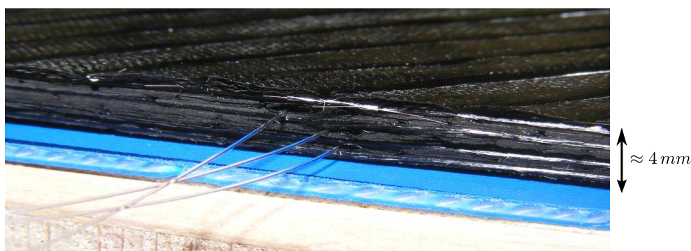
Figure 2.21: Fibres optiques mises en place dans une préforme.
