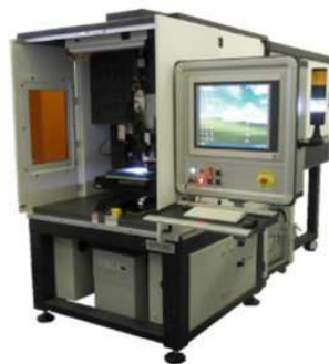
Figure 4.4: Plateforme de micro-usinage MUSE 3D, développée par la société Optec.
