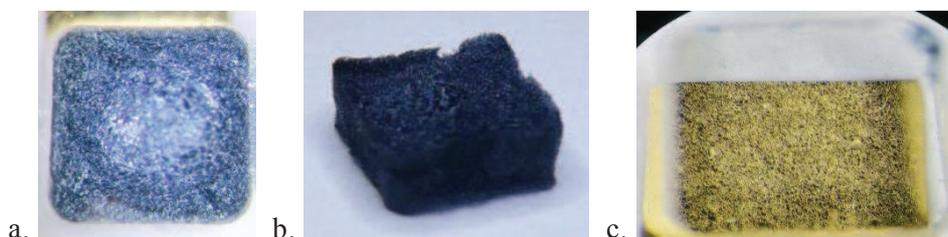
**Figure 4-16 : Photographies sous binoculaire du matériau obtenu après lyophilisation (dimension 4\*4\*2mm) : a. dans son puits ; b. sorti du puits, et c. le fond du puits.**
