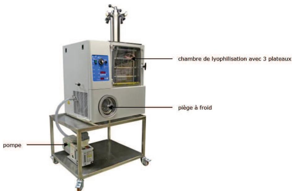
**Figure A 8 : Lyophilisateur pilote de paillasse de Cryotec,**
