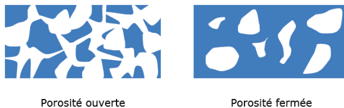
Figure 4-2 : Représentation schématique de matériaux à la porosité ouverte et fermée.
