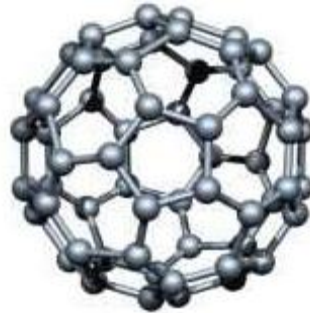
Figure I—4 Structure du fullerène C60
