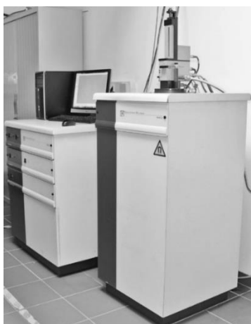
Figure 11 : Photographie d'un des magnétomètres à SQUID présent au sein du groupe Molécules et Matériaux Commutables de l'ICMCB
