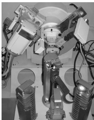
Figure 18 : Photographie du diffractomètre sur poudre utilisé pour la caractérisation des composés à transition de spin à l'ICMCB : Diffractomètre PANalytical X'pert PRO MPD
