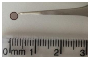
Figure 4 : Photographie d'une grille de microscopie électronique en transmission à base de cuivre recouverte d'un film de carbone.
