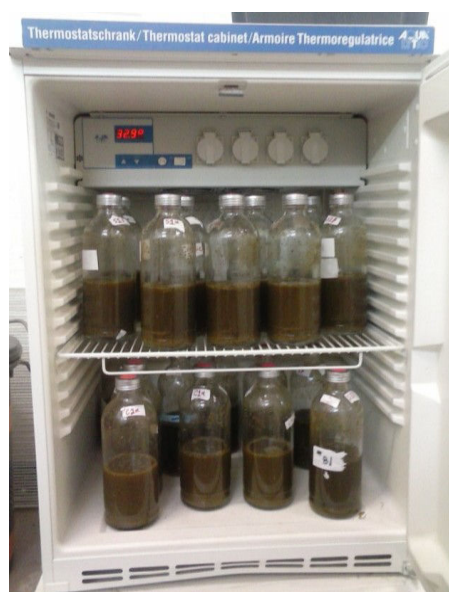
Figure II.1 : Tests BMP en incubation à 37 °C dans l'armoire thermorégulatrice
