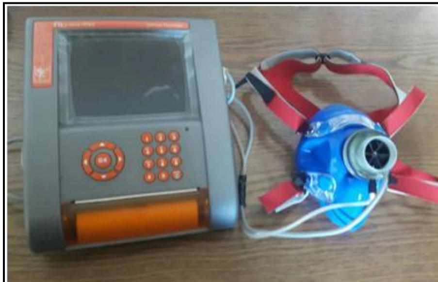
Figure 42 : L'appareil de mesure de la VO_2 (Cosmed Fimate pro)
