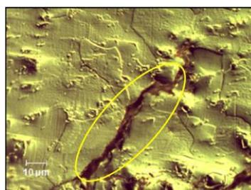
Figure 1.10. Fissuration intergranulaire d'une éprouvette SAC105 après un vieillissement de 21 jours à 125°C [15].
