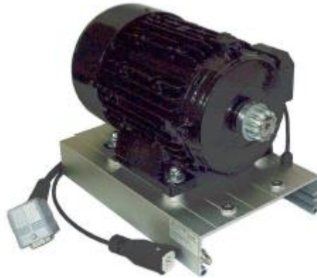
Figure C.5 : Machine asynchrone utilisée pour l'émulation de la turbine hydrolienne
