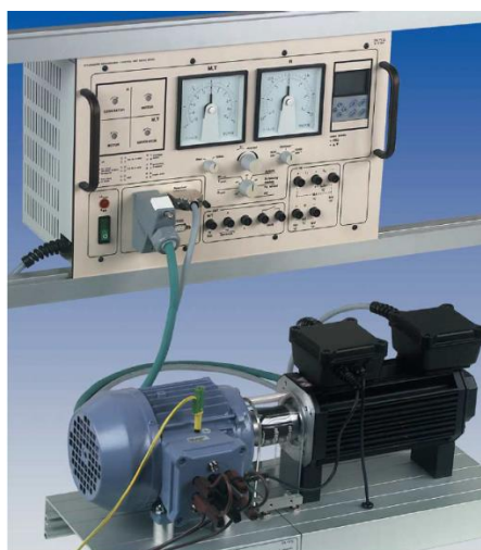
Figure C.7 : Le moteur asynchrone couplé avec le frein et son unité de commande, pour l'émulation de la turbine hydrolienne
