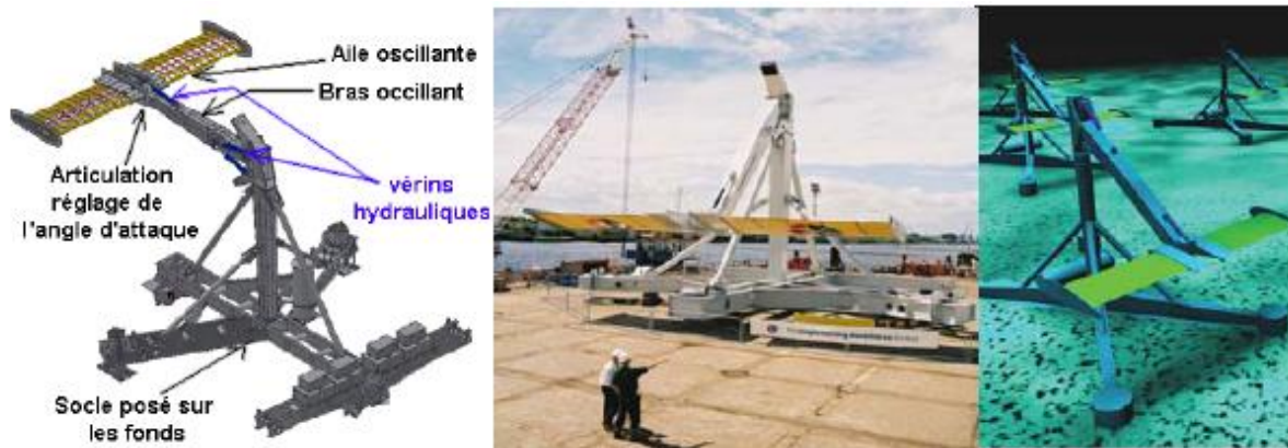
Figure I.30 : Système STINGRAY détaillé, prototype en photo et image d'une ferme sous-marine [73]
