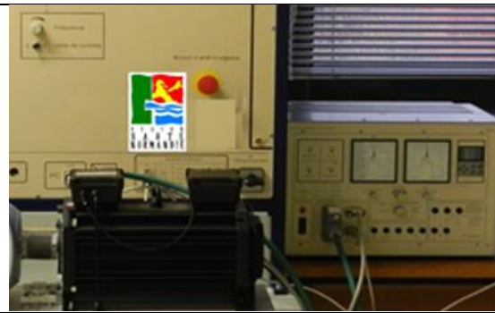
Figure IV.36 Le frein actif : la machine autopilotée et son unité de commande
