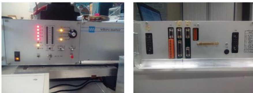
Figure IV.26 : L'unité (vue de face et de derrière) pour la commande du frein à poudre
