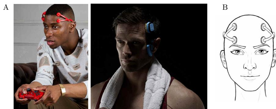
FIGURE 2.3 – L'appareillage *foc.us*. A) Photos tirées du site promotionnel de l'appareil, [www.foc.us](http://www.foc.us). B) Schéma du montage des électrodes pour le stimulateur *foc.us*, selon les spécifications fournies à l'achat ; adapté de [Steenbergen et al. \(2015\)](#).
