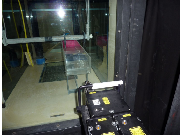
Figure III.3 : Plaque perforée montée sur le sluice
