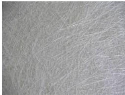
Figure 1-2: Mats de fibres de carbone
