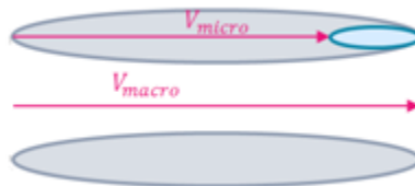
Figure 3-18 : Création d'une micro-bulle d'air
