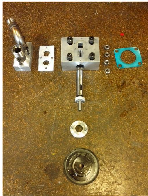
(b) Système de distribution démonté
