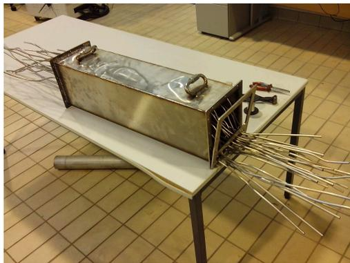
(c) Assemblage de l'échangeur
