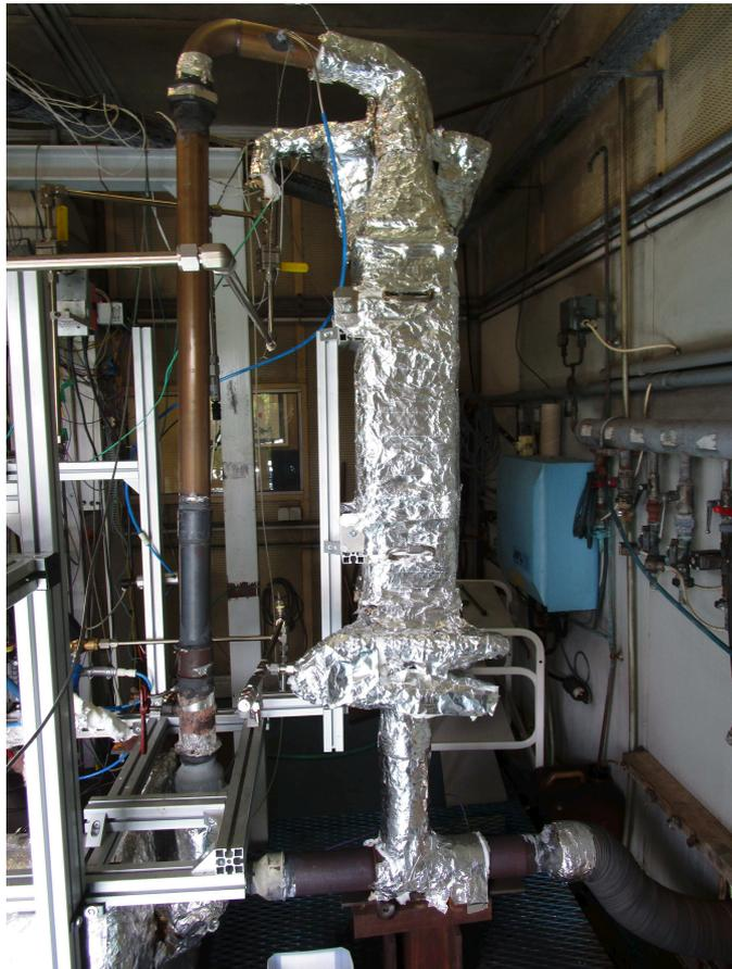
FIGURE 2.6 – Échangeur-évaporateur
