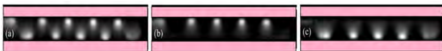
FIGURE 1.30 – Tube 1D. Régime filamentaire quinconce dans le néon à 50Torr, 30kHz et 150V. a) Période entière. b) Demi période 1. c) Demi période 2. [52].
