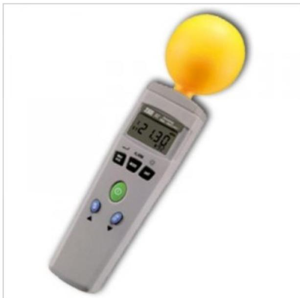
Le mesureur d'ondes hautes fréquences **TES-92** permet une mesure facile et rapide de l'electrosmog, soit des rayonnements Hautes fréquences et micro ondes émis par les téléphones portables, les antennes GSM, UMTS, 4G, Wi-Fi, DECT, les ondes radio et TV, les fours à micro-ondes, baby-phones, etc. **(50MHz à 3.5GHz)**
