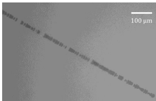
Figure 101 : Rayure de polissage observée sur la surface d'un composant de grande taille du LMJ
