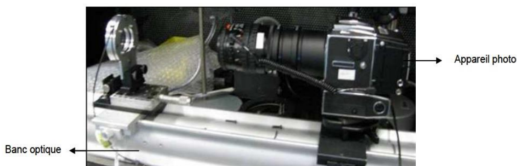
Figure 81 : Photographie du banc d'observation DMS des défauts d'aspect monté en configuration pour échantillons de diamètre 50 mm.
