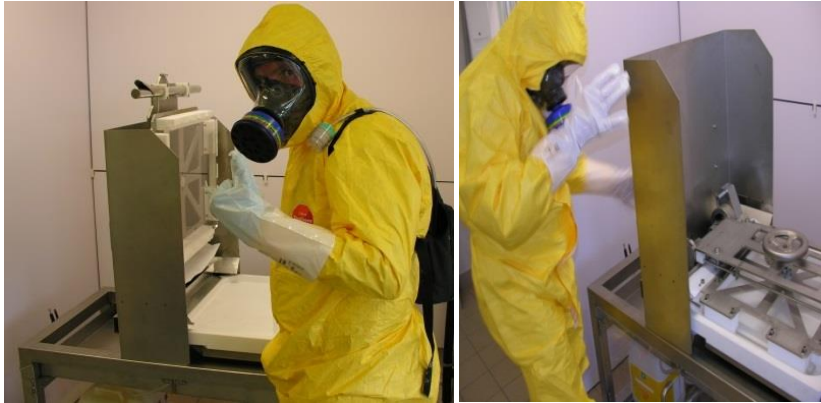
Figure 121 : Système de traitement chimique utilisé par le CEA pour les optiques du LMJ
