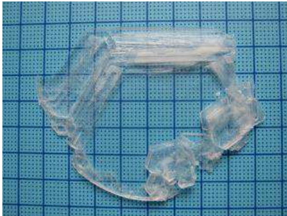
Figure 3: Monocrystal de KBBF de dimension 50 \times 40 \times 3,7 \text{ mm}^3 élaboré en flux \text{KF-B}_2\text{O}_3 par la méthode de cristallisation spontanée par refroidissement lent localisé
