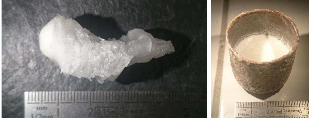
Figure 48 : Cristal issu de la charge [Ca_{0,7}Sr_{0,3}]_5(BO_3)_3F élaboré par la méthode Czochralski et son creuset en fin de tirage
