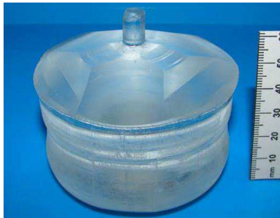
Figure 1: Monocristaux de BBO de dimension 55x50x50mm 3 (0,8kg) élaboré par la méthode TSSG [8]
