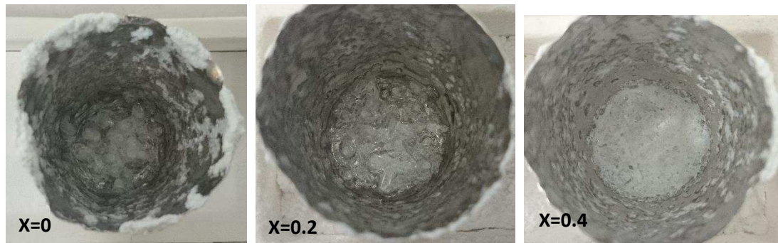
Figure 39: Creusets après refroidissement lent de bain de composition 1\text{YAB}+(2-x)\text{LaB}_3\text{O}_6+x(3/2\text{B}_2\text{O}_3+1/2\text{Y}_2\text{O}_3)
