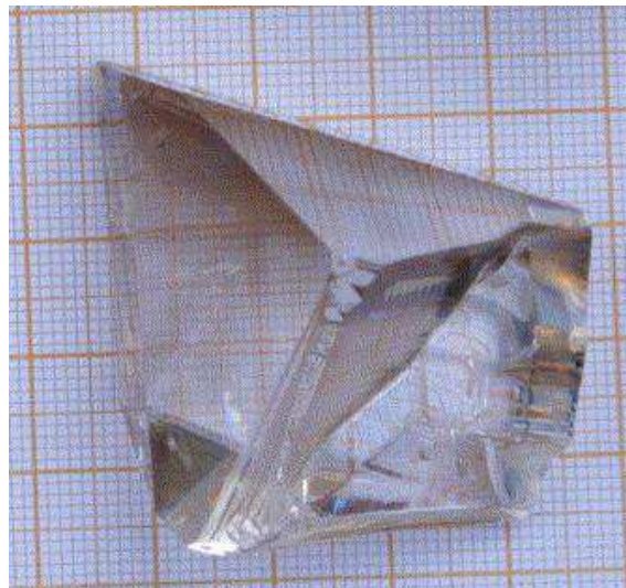
Figure 6 : Cristal de BIBO obtenu avec un germe orienté [\bar{1}01] et de dimension 30 \times 30 \times 40 \text{ mm}^3 , pour une masse de 120g. [38]
