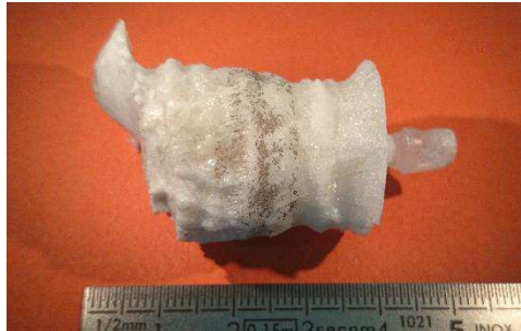
Figure 29 : Photo du monocristal de CBF4 synthé par la méthode Czochralski en flux \text{CaF}_2
