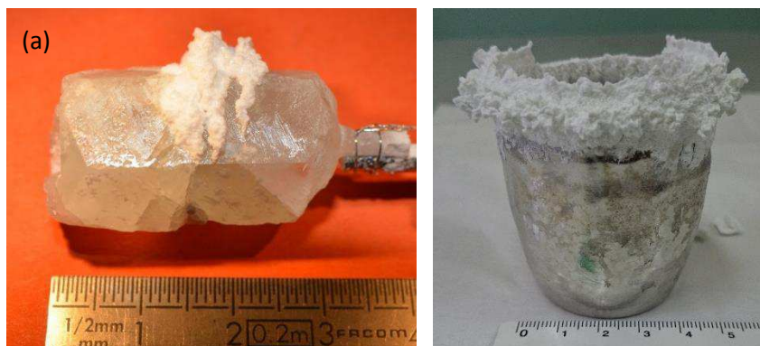
Figure 23: Photo du monocristal de YAB (14Z2YAB2) élaboré avec la composition 1YAB+1,4LaB3O6+0,4KF (a) et creuset en fin de croissance (b)
