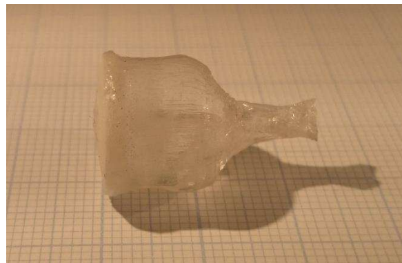
Figure 50 : Monocristal issu de la charge [Ca_{0,8}Sr_{0,2}]_5(BO_3)_3F élaboré par la méthode Czochralski avec la composition 20SCBF+80LiF (%mol)
