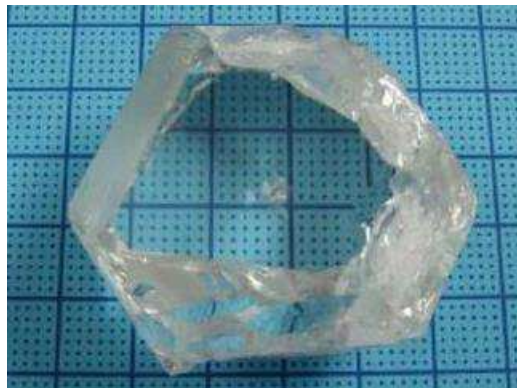
Figure 8 : Monocristal de BABF synthétisé en flux LiF-B 2 O 3 -NaF [70]
