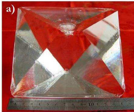
Figure 10: Monocristal de CLBO élaboré par la méthode TSSG
