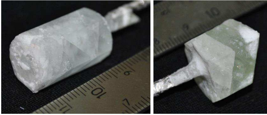
Figure 17: Cristaux de YAB élaborés avec un bain de composition 1\text{YAB}+2\text{LaB}_3\text{O}_6 (%mol)
