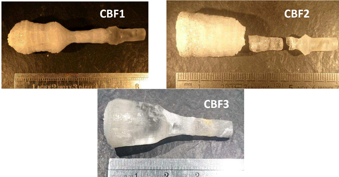
Figure 26 Photo de cristaux de CBF obtenus par la méthode Czochralski avec la composition 80CBF+20LiF (% massique)
