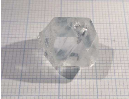
Figure 59: Monocrystal de YAB élaboré en flux 1\text{YAB}+1,6\text{LaB}_3\text{O}_6+0,2\text{LiF}+0,2\text{KF} (16Z3YAB14) et traité en creuset graphite.
