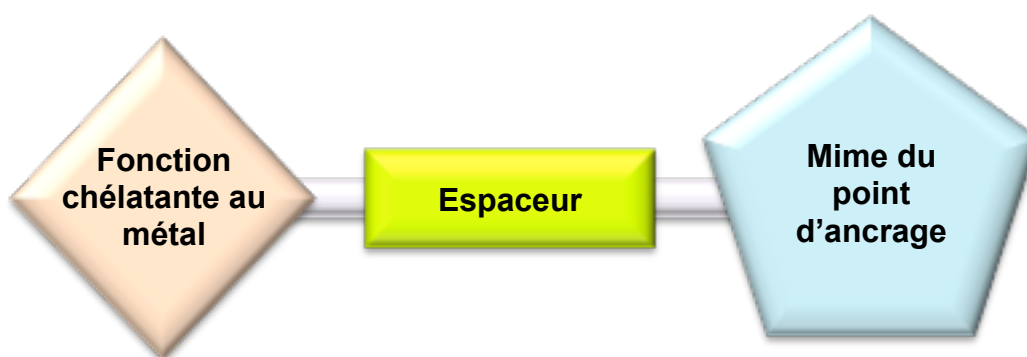
Figure 7: Architecture générale des différents inhibiteurs.
