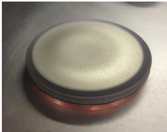
Figure III-2: Photographie de la cible \text{FeS}_2 : \text{TiS}_2 (75:25) de 50 mm de diamètre collée sur support de cuivre, après 4 heures de pré-pulvérisation.
