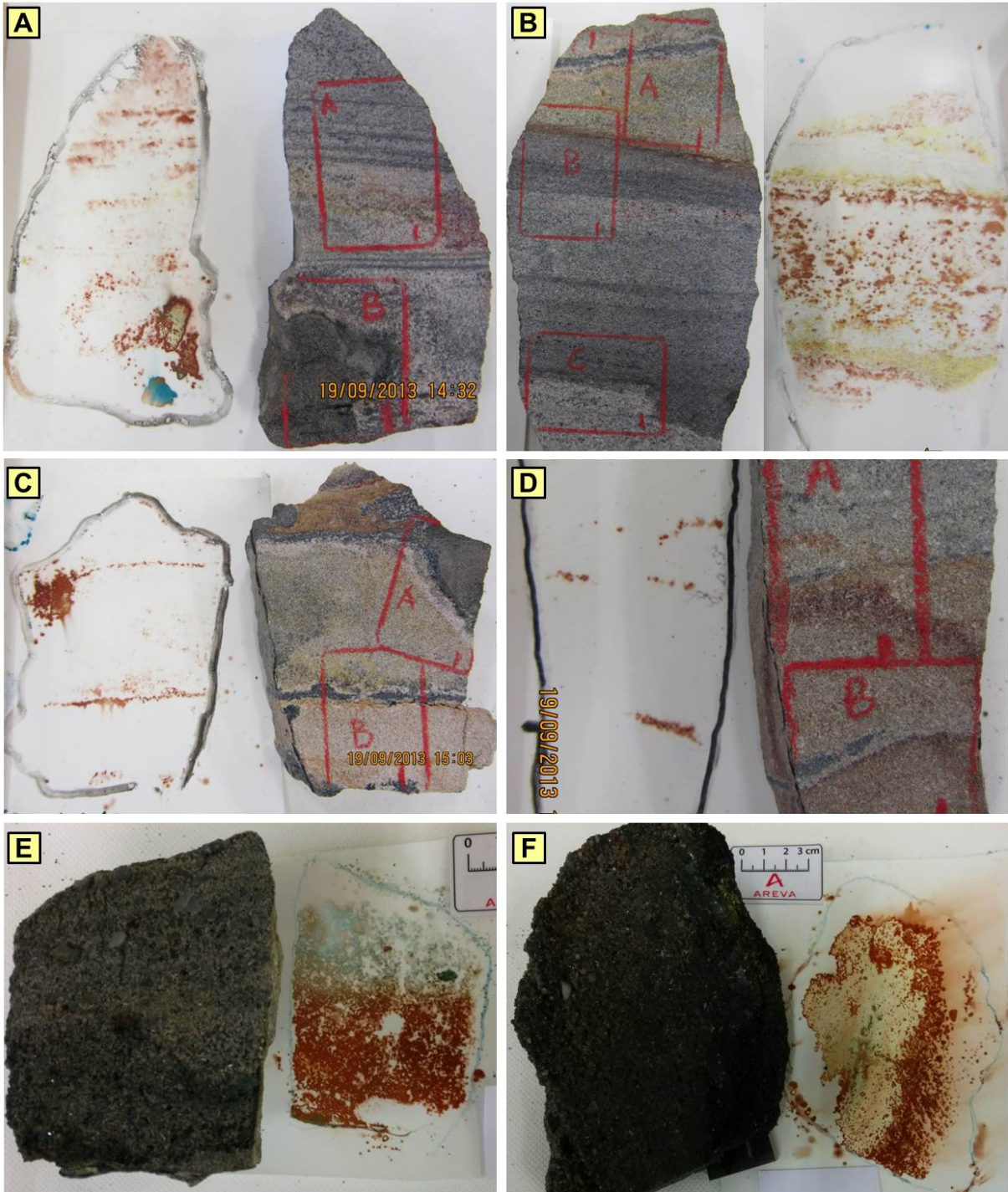
Figure 37 : exemple de résultats d'empreintes de Hiller sur quelques échantillons d'Akouta et Arlit. La couleur maron sur la couche de gélatine traduit la présence de l'uranium.
