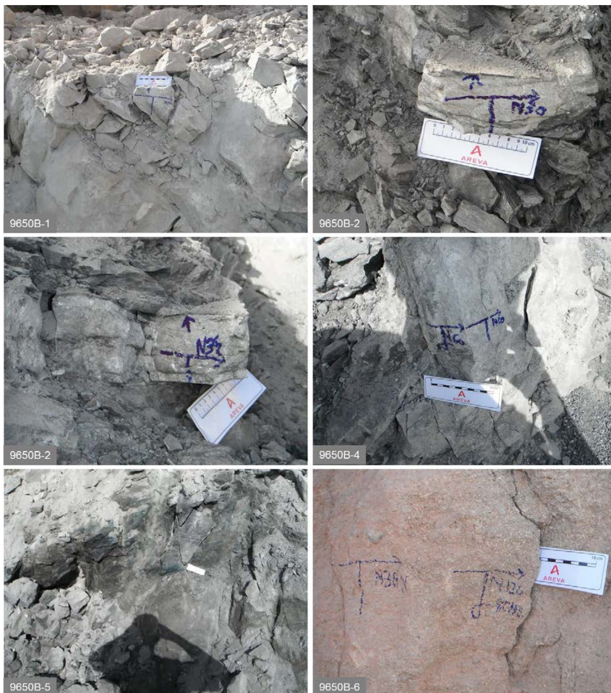
Figure 24: Carrière en exploitation de Tamgak. Echantillon 9650B-1 : Tarat, microconglomérat à ciment kaoliniteux. Orientation N100, 60°S ; SPP = 750 c/s. Echantillon 9650B-2 : Tarat, grès très fin silteux, orientation face 1 N30, 95S ; SPP = 720 c/s ; et face 2 (N35, 90W) dans son contexte, SPP = 720 c/s. Echantillon 9650B-3 : Tarat, grès moyen à grossier à ciment kaoliniteux. Orientation face 1 N60, 80S, pendage inverse, et face 2 N10, 80W, pendage normal. Echantillon 9650B-4 : Tarat, grès grossier très réduit. Orientation face 1 N70, 70N, pendage normal, et face 2 N160, 60E; SPP = 840 c/s. Echantillon 9650B-6 : Izégouande, grès très grossier à microconglomératique oxydé. Orientation face 1 N130, V, et face 2 N120, 80NE, pendage inverse.
