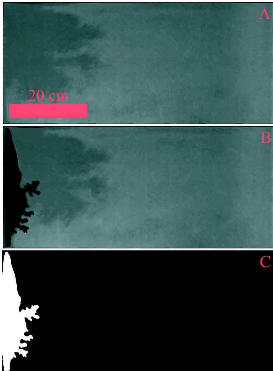
Figure 1.10: Les images de la cellule de Hele-Shaw après la binarisation des photos. Cela nous permet d'étudier uniquement les structures issues de la chenalisation et ainsi obtenir leurs dimensions fractales.
