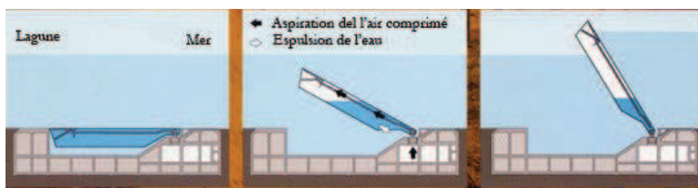
Figure 4. Le fonctionnement des cloisons mobiles du système MOSE (propriété de l'image : Consorzio Venezia Nuova)
