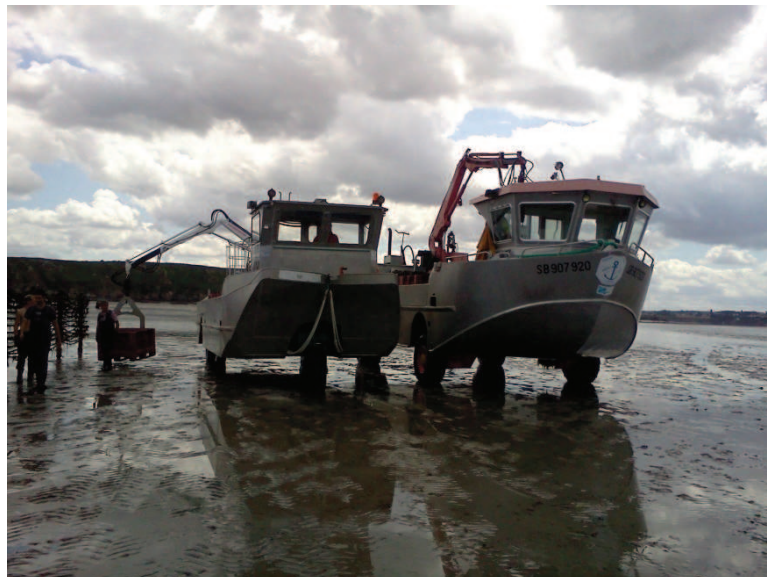
Figure 28. Deux amphibies avec leurs grues au travail sur les bouchots
