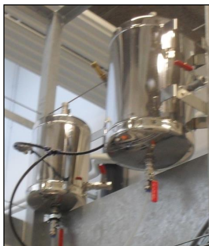
Figure E.4. Vue des cuves d'alimentation sous pression
