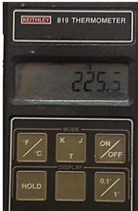
Figure 72 : Température du substrat du composant à 225°C
