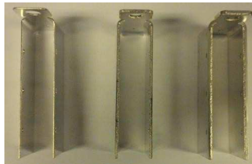
Figure 89 : Les trois épaisseurs testées du refroidisseur
