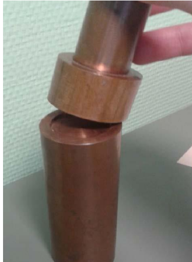
Fig. 3.4 - Support en cuivre pour l'élaboration, sous forme d'une lame, des verres riches en alcalin
