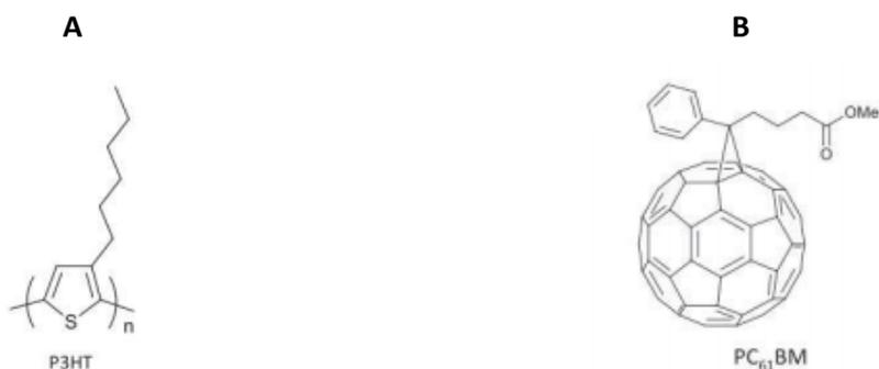
Figure 108 : Structure du du P<sub>3</sub>HT (A) et PC<sub>61</sub>BM (B)
