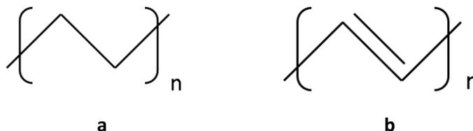
**Figure 6 : Structure du polyéthylène (a) et du polyacétylène (b)**
