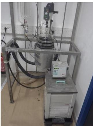
Figure 31 : Réacteur équipé d'un cryostat utilisé lors de la synthèse de la polyaniline
