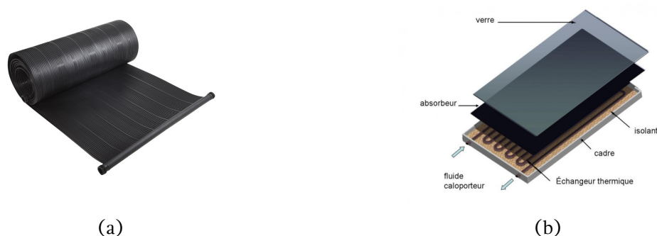
FIGURE I.13 – Exemple de capteur plan non vitré (a), et vue explosée d'un capteur vitré (b).
