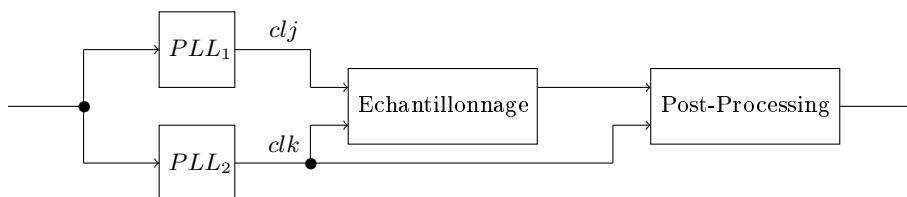
FIGURE 2.5: NDRBG basé sur l'échantillonnage cohérent utilisant des PLL.
