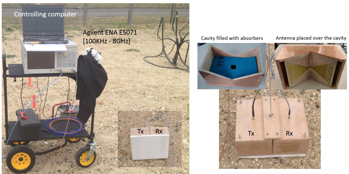
FIGURE 4.16 – Le système de mesure GPR : l'analyseur de réseau vectoriel et l'ordinateur de contrôle (gauche), VFBA antennes d'émission et réception (droite).
