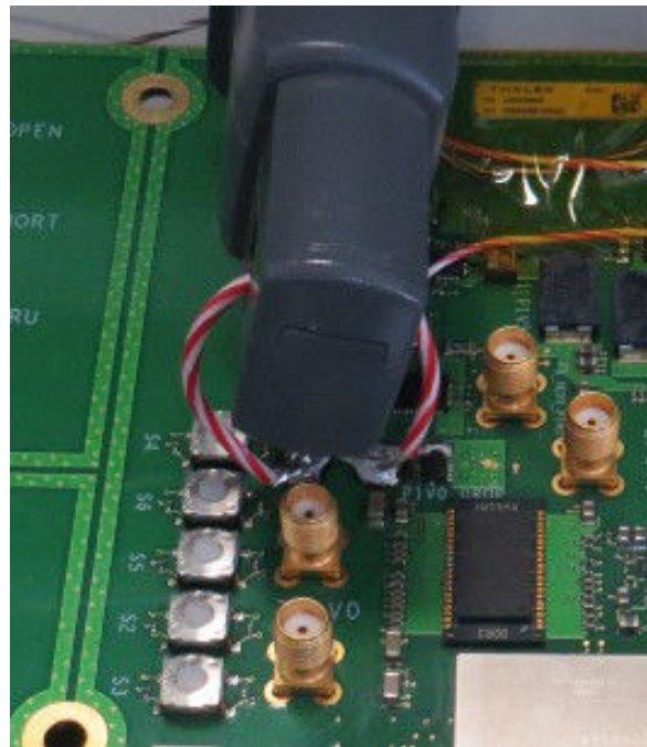
FIGURE 4.60 – Photographie de la manipulation de mesure du courant
