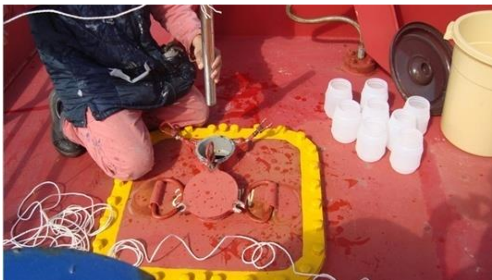
Fig. 5a. Protocole d'échantillonnage d'eau de ballast en utilisant une pompe de forage à bord d'un Pétrolier (Fartouna-Bellakhal, 2012)
