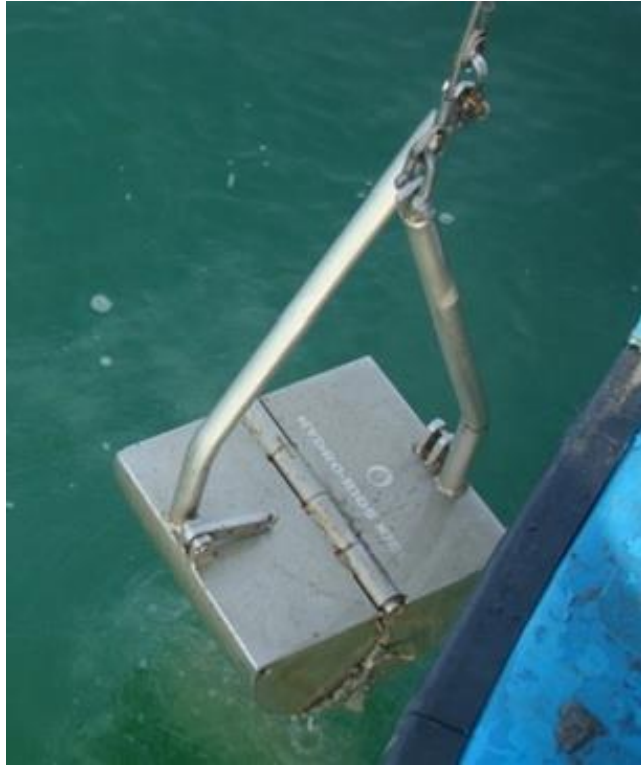
Fig. 6a. Utilisation de la benne Van venn (Fartouna-Bellakhal, 2012)
