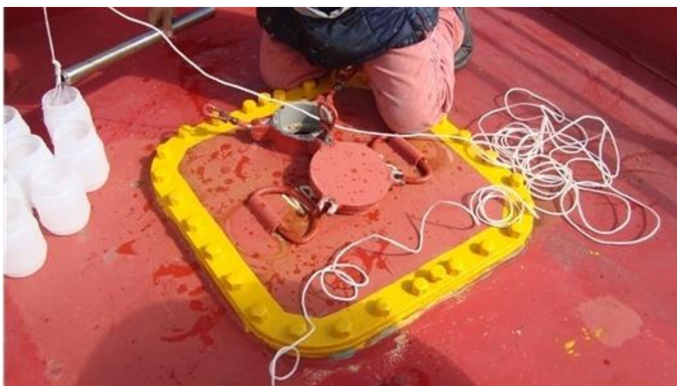
Fig. 5b. Vidange de l'eau de ballast dans les bouteilles de prélèvement à bord d'un pétrolier (Fartouna-Bellakhal, 2012)
