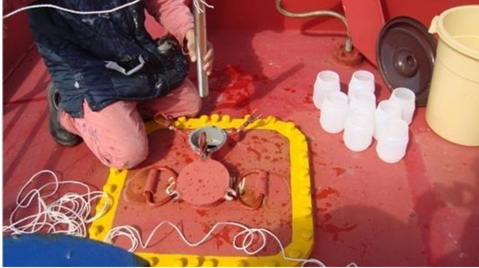
Fig. 5a. Protocole d'échantillonnage d'eau de ballast en utilisant une pompe de forage à bord d'un Pétrolier (Fartouna-Bellakhal, 2012)
