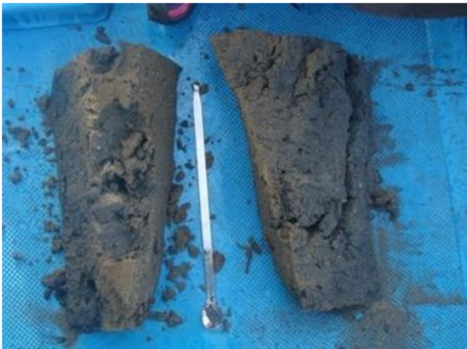
Fig. 6b. Sédiment récupéré à l'aide de la benne (Fartouna-Bellakhal, 2012)
