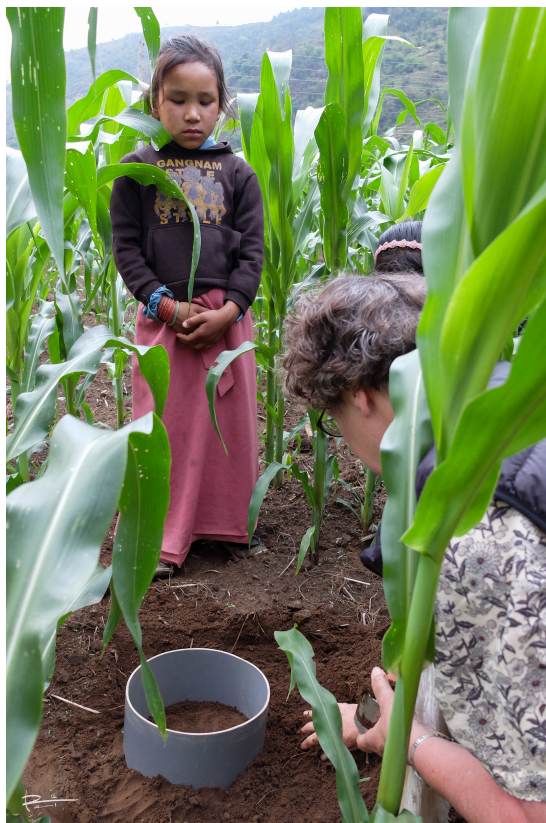
FIGURE 3.7 – Mise en place d'un test BeerKan sur la parcelle François . Photo Rémi Muller.
