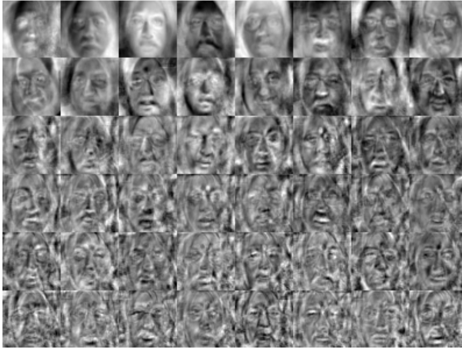
FIGURE 2.4 – Exemple d' Eigenfaces de TURK et PENTLAND [1991] . Tout visage peut se décomposer comme une somme pondérée des visages ci-dessus et d'une perte qui dépend d'un nombre de dimension choisi pour la PCA .
