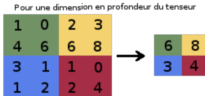
FIGURE 3.6 – Max pooling avec un filtre 2x2 et un pas ( stride ) de 2. WIKIPEDIA [2017]
