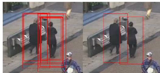
(c) Détections retenues avant et après l'application d'une NMS [PRISACARIU et al., 2009]
