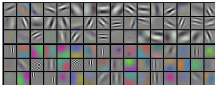
FIGURE 3.4 – Exemples de filtres de convolution : les 96 filtres de la première couche d'AlexNet [ KRIZHEVSKY et HINTON, 2009 ].
