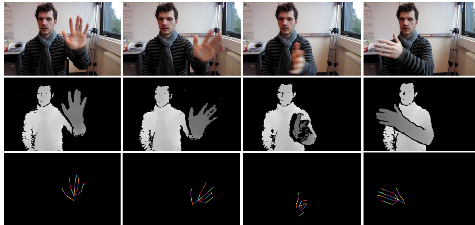
FIGURE 5.2 – Exemple de mouvement du challenge 3D Hand Gesture Recognition : "Swipe left". Image extraite de http://www-rech.telecom-lille.fr/shrec2017-hand/
