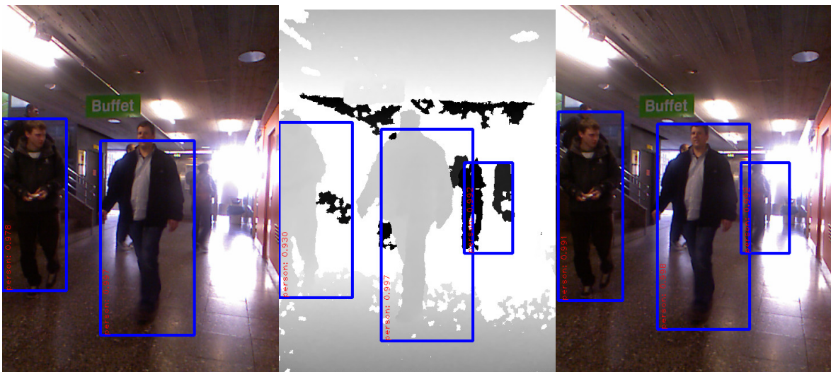
FIGURE 5.15 – Exemples de Prédictions sur RGBD People . Modèles entraînés et testés sur le jeu de données RGBD People LUBER et al. [2011]. De gauche à droite : expert RGB , expert Depth , fusion en X. L’expert Depth est parvenu à trouver l’ensemble des personnes dans l’image mais la fusion en X propose des boîtes englobantes qui sont mieux alignées avec la vérité terrain.
