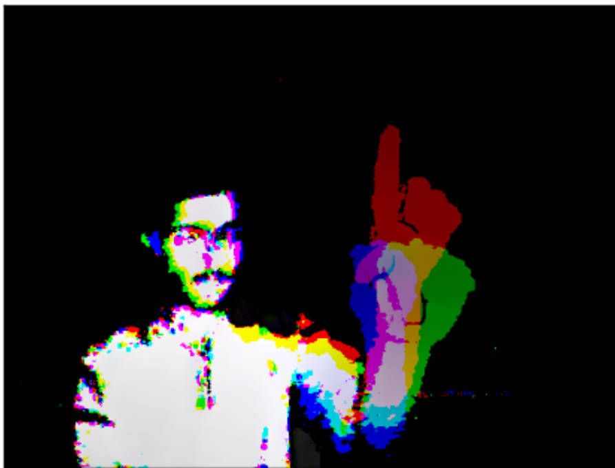
FIGURE 5.3 – Exemple d'encodage pour le workshop SHREC . Le mouvement représenté ici est un pincement avec seulement deux doigts. La main part du haut (rouge), se referme assez rapidement en descendant (vert) et fini vers le bas complètement pincée (bleu)
