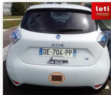
(b) Un LIDAR ibeo LUX derrière
