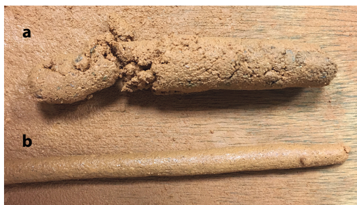
Fig. V.3. Façonnage de colombins en terre granitique du massif des Maures-Tanneron, a) sans ajout de matière organique ; b) avec 1% (en masse) de cire d'abeille. Photo L. Gomart.
