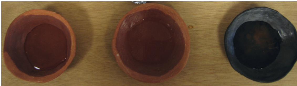
Fig. III.4. Tests d'imperméabilité de céramiques expérimentales. Photos L. Drieu.
