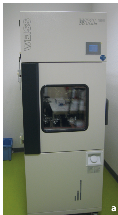
Fig. III.10. a) Enceinte climatique utilisée pour la dégradation artificielle de la matière organique absorbée dans les éprouvettes expérimentales ; b) Disposition des cristallisoirs et des béchers remplis de terreau dans la chambre de l'enceinte climatique.
