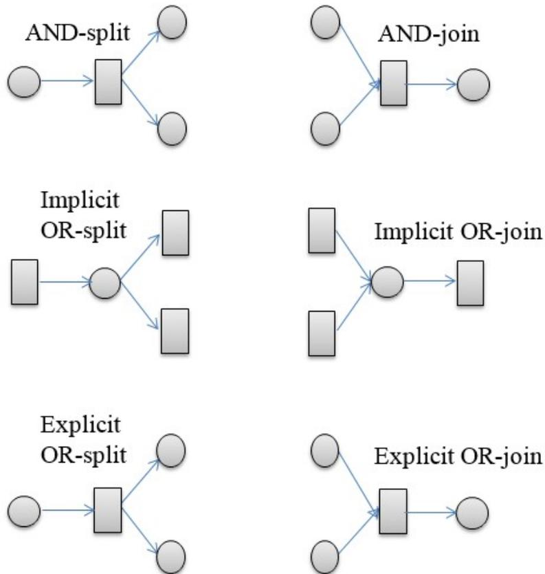
Figure 4.1: Bloc de base de la structure de routage
